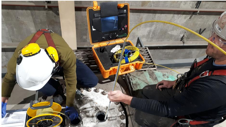
*Figure 3. Prise de mesure de la hauteur de liquide*
