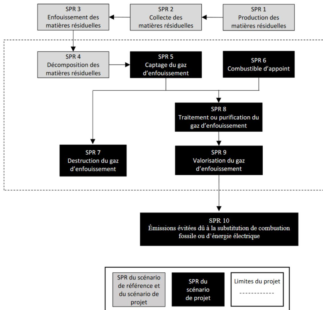
**Figure 1 – Illustration des limites du système**
