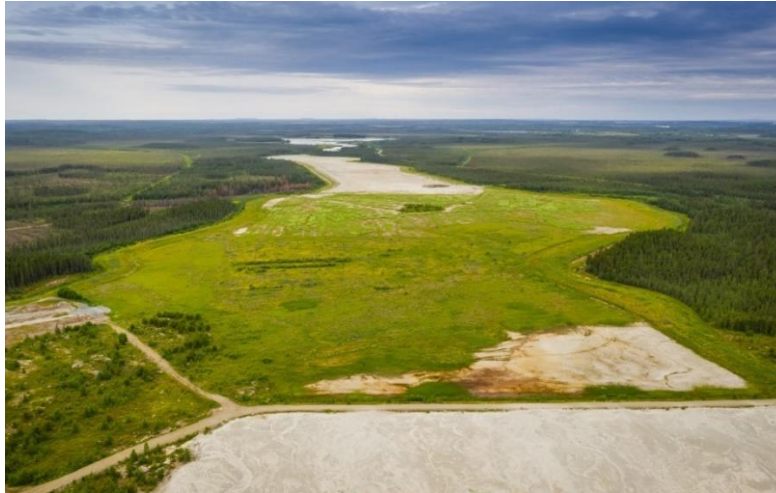
Figure 4 : Technique de la NPS avec recouvrement monocouche mise en place sur le parc à résidus #2 du site Manitou (Abitibi-Témiscamingue, Québec)
