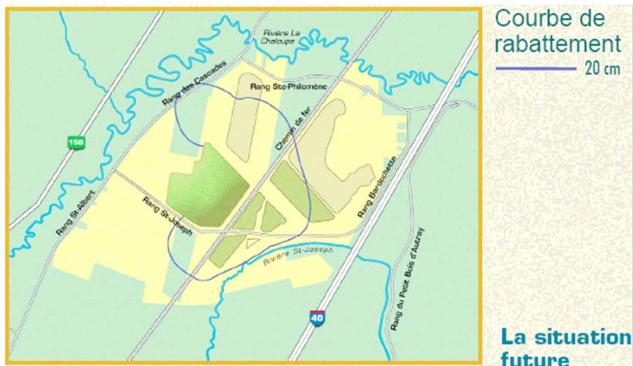
Figure 7 : Courbe d'abattement maximal de la nappe d'eau libre
