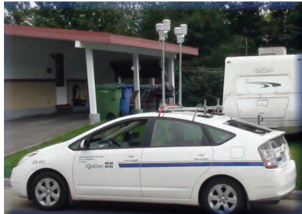
Photo 2 : Véhicule muni de sondes ayant servi à l'échantillonnage mobile ponctuel
