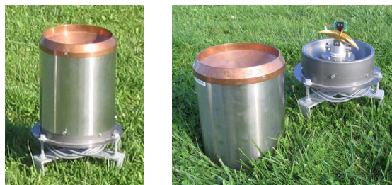
Figure 1 Pluviomètre à augets basculeurs en position de fonctionnement et ouvert
