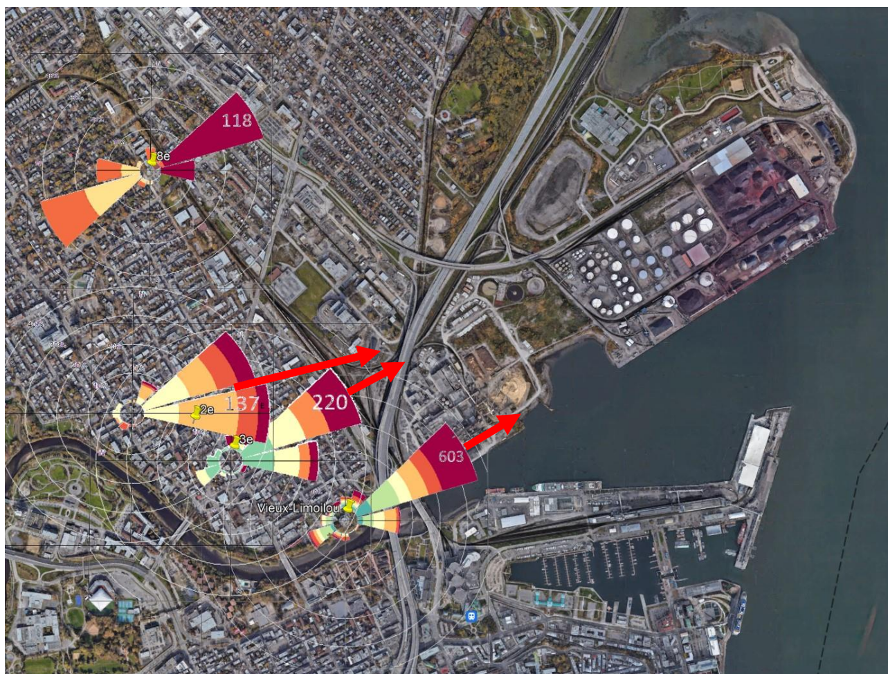
Figure 3.54 - Roses de pollution des concentrations de nickel dans les \text{PM}_{10} aux trois stations de l'APQ et celle du Vieux-Limoilou (MELCCFP) reportées sur une carte géographique du quartier Limoilou. Ces roses tiennent compte de la direction et de la vitesse des vents mesurés à la station Beauport (SMC; voir rose des vents à la figure 3.53)
