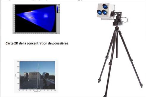
Lidar à numérisation (Aéromap )
