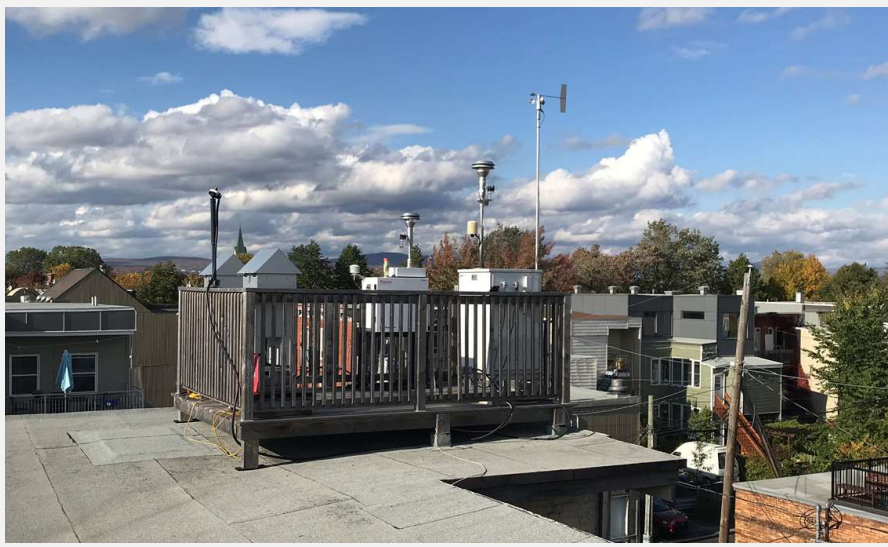
STATION 3 e AVENUE - ACTIVE DEPUIS 2016 SHARP 5030, PARTISOL 2025I, HI-VOL, MET-ONE 034B
