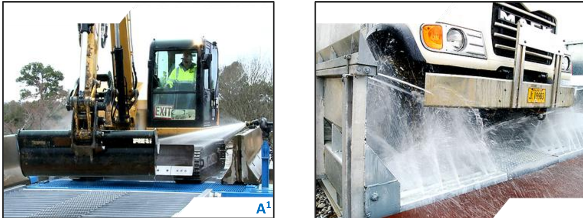
Figure 5.4. Exemples de systèmes de lavages de roues de véhicules industriels utilisés dans des projets de construction et de réfection
