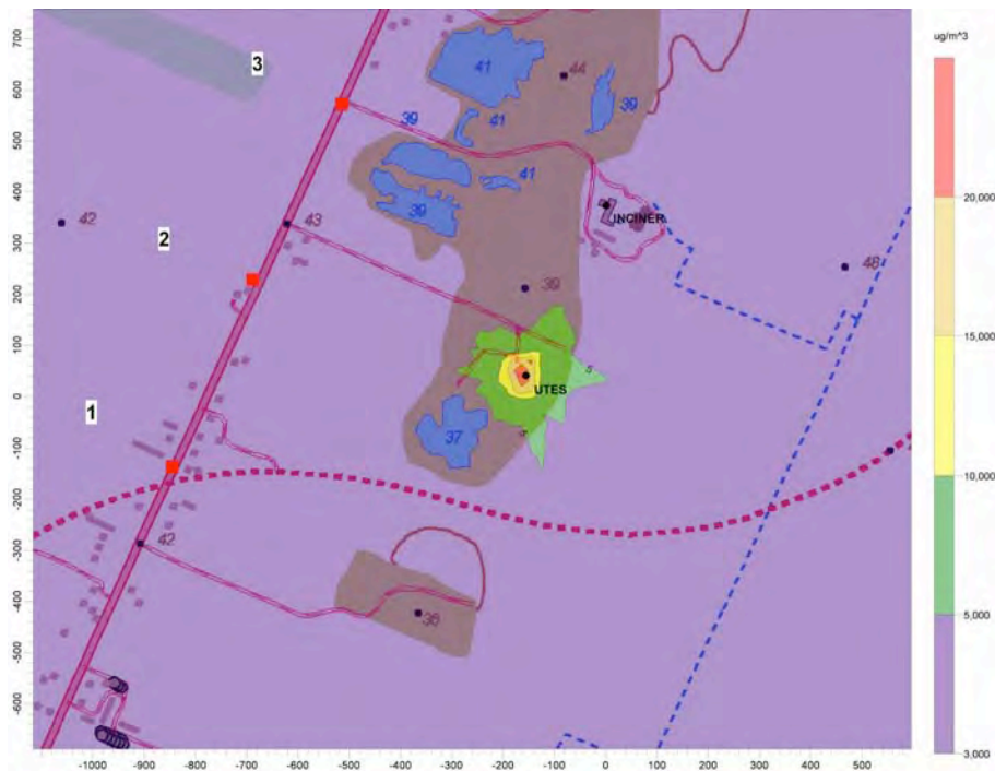
Figure 10 Concentrations quotidiennes maximales de benzène dans l'air ambiant résultant des émissions de l'UTES. Une concentration initiale de 3 \mu\text{g}/\text{m}^3 a été ajoutée aux concentrations modélisées. Le critère provisoire de gestion du MDDEP ( 10 \mu\text{g}/\text{m}^3 ) est dépassé à l'intérieur d'une zone (en jaune ou orange) qui s'étend sur une distance de quelques dizaines de mètres autour de l'UTES
