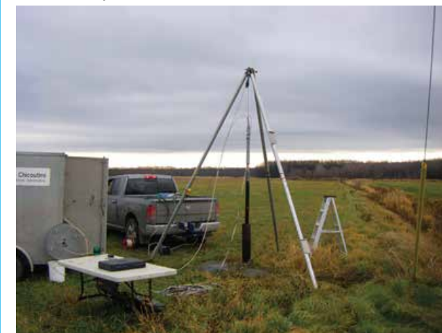
Essai d'injection entre obturateurs
