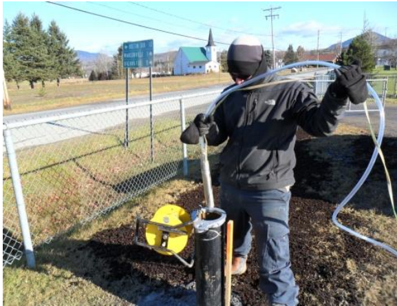
Figure 2.10 : Pompes utilisées pour la purge et l'échantillonnage des puits d'observation
