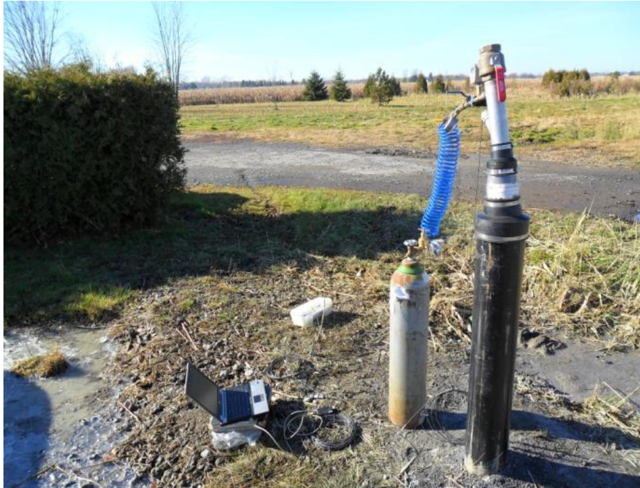
Figure 2.6 : Instrumentation pour l'essai de perméabilité pneumatique sur un puits
