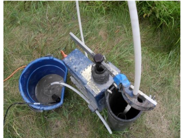
Figure 2.10 : Pompes utilisées pour la purge et l'échantillonnage des puits d'observation
