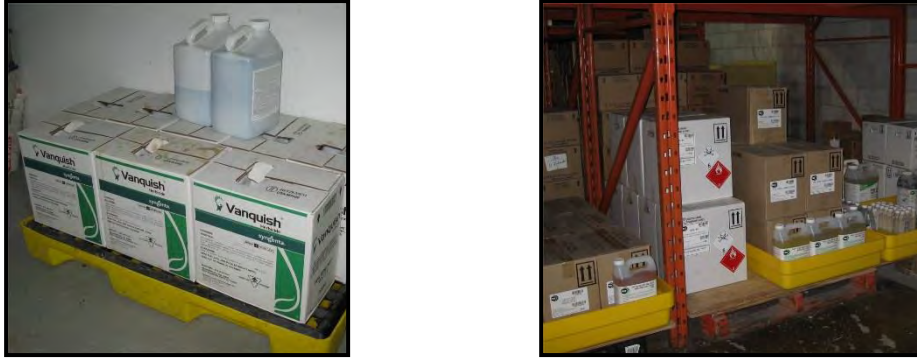
Figure 3.4 Pesticides entreposés dans un aménagement de rétention
