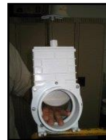
Figure 2.4 Valve permettant l'évacuation du contenu d'un bassin de rétention
