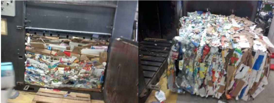
Photographie 9 : Presse à carton et ballot multimatière (source : Michel Perron, Services-Conseils GMR)
