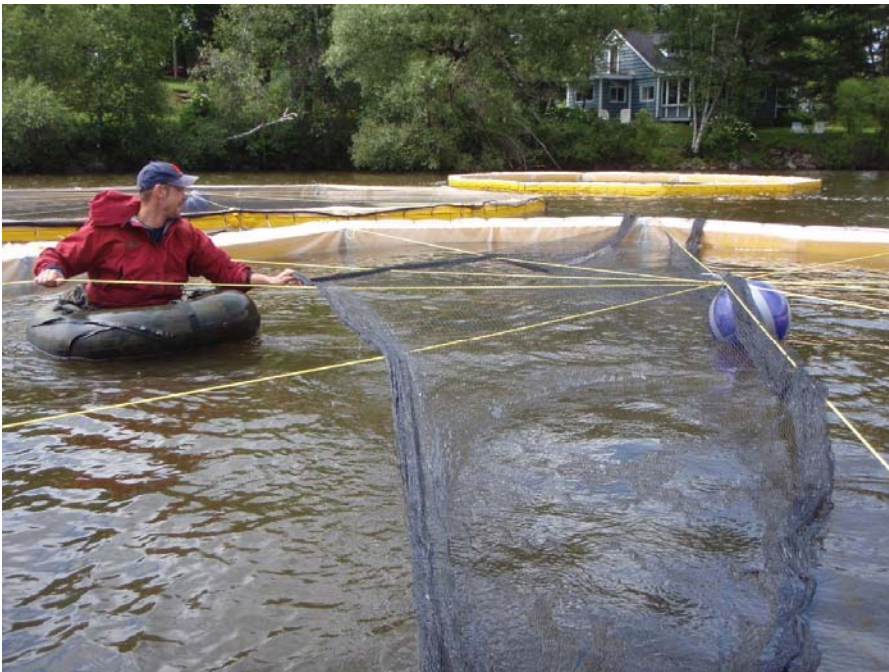
Photo 4 : Installation du filet protecteur contre les oiseaux
