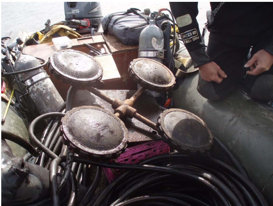
Photo 10 : Diffuseur d'air utilisé pour brasser les sédiments à la station BRA
