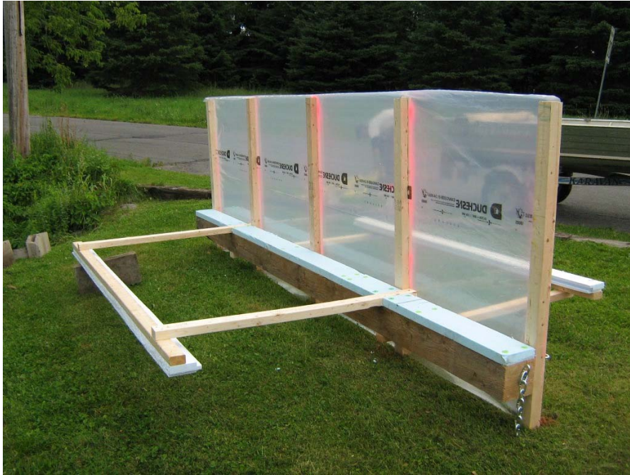
Photo 1 : Section d'une estacade
