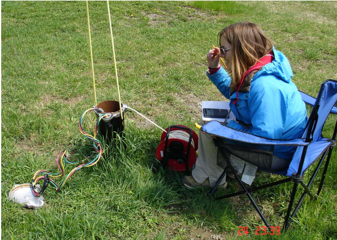
Photo 2-9 : Mesure du rabattement et de la remontée occasionnés par la purge du puits préalable à l'échantillonnage hydrogéochimique
