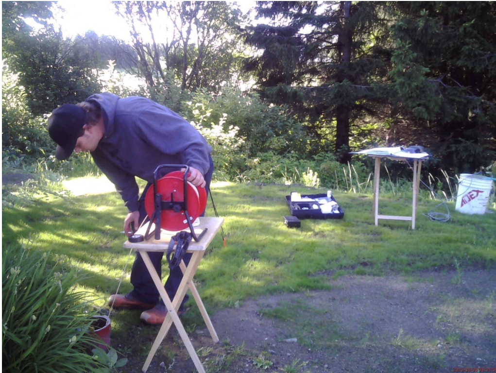
Figure 2-7 : Mesure du niveau d'eau dans le puits pendant l'essai de pompage.
