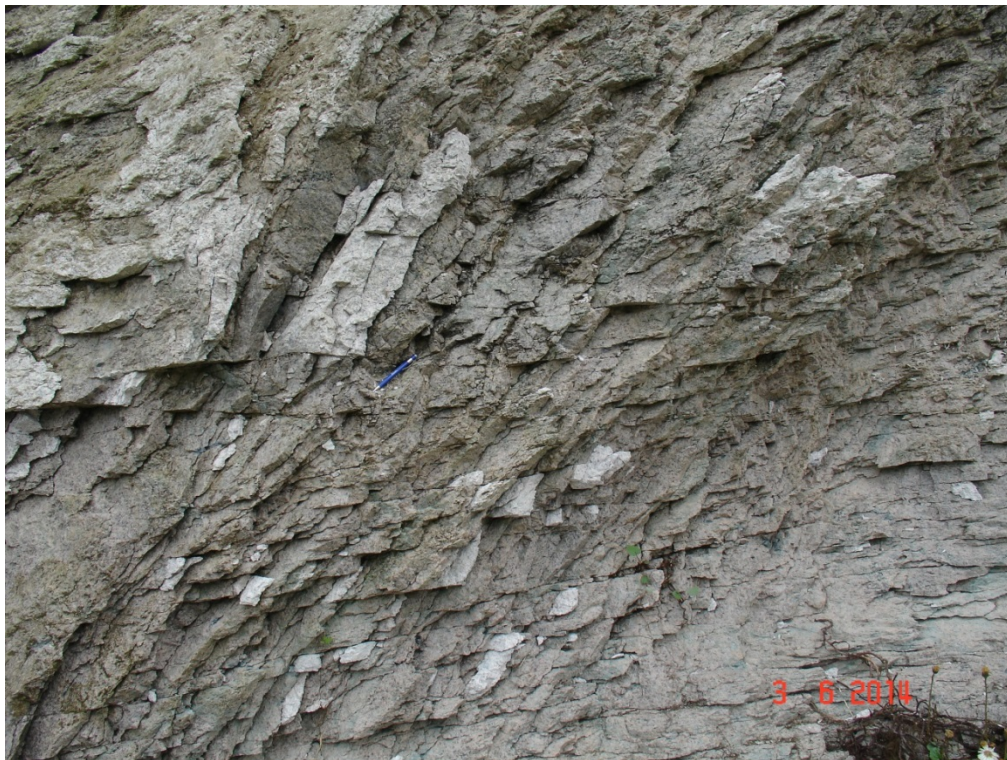
Figure 4-13 : Affleurement observé en bordure de la rivière du Gouffre à la hauteur de la fosse Antonien montrant la fracturation importante de l'anorthosite de Saint-Urbain avec un indice de fracturation de 5 (photo AFF002-3).
