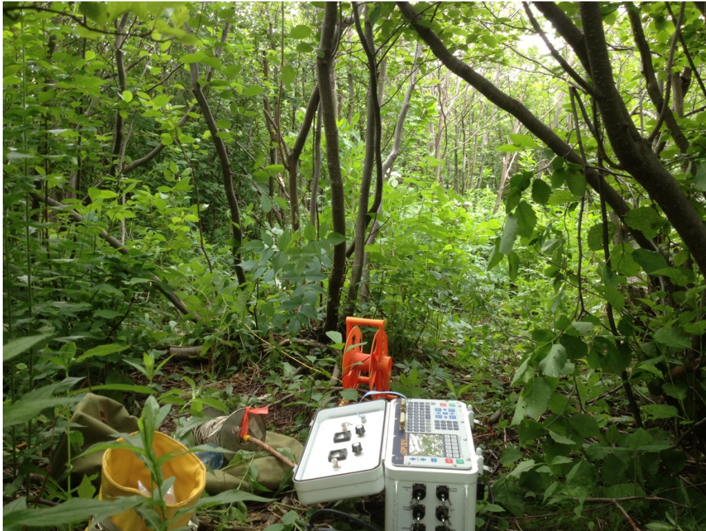
Figure 2-2 : L'appareil NanoTEM NT32 est petit et léger, ce qui permet de l'utiliser dans des contextes forestiers.
