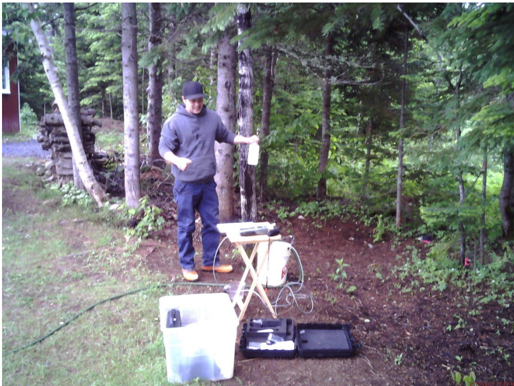
Figure 2-9 : Le prélèvement d'échantillon d'eau souterraine se fait dans des bouteilles approuvées par le laboratoire d'analyse.
